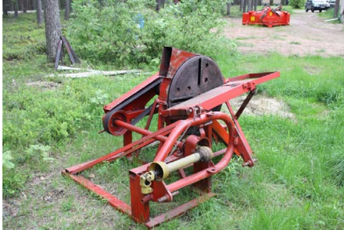
Kuva 2. Itserakennettu aitatolppien teroituslaite.
